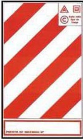
“Para señalar la ubicación de un matafuego se debe colocar una chapa caliza, tal como lo muestra la siguiente figura. Esta es una superficie con franjas inclinadas en 45° respecto de la horizontal blancas y rojas de 10cm de ancho. La parte superior de la chapa debe estar ubicada a 1,20 m a 1,50 m respecto del nivel del piso”.
