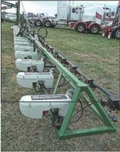
Figura 2: Weed Seeker instalado en una pulverizadora.
