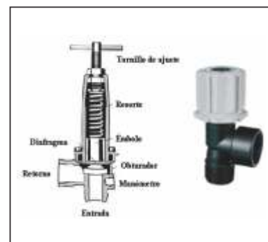
Figura 5: Dos tipos de válvulas manuales aliviadoras de presión.
