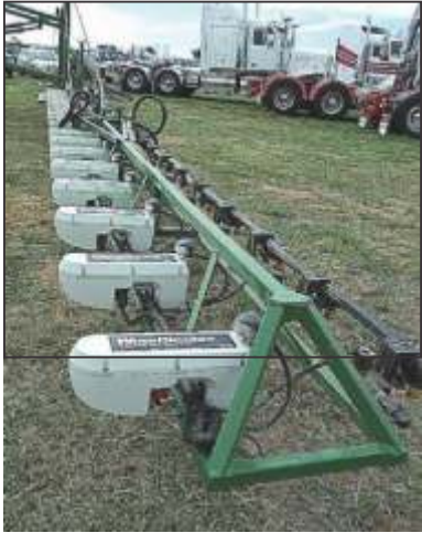
Figura 2: Weed Seeker instalado en una pulverizadora.
