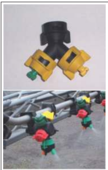
Figura 11. Picos y tapas doble semejante al efecto de las pastillas Twin.
